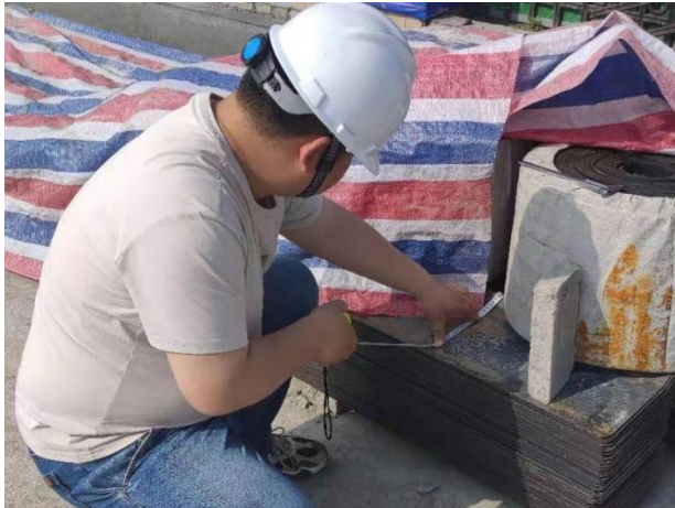
止水钢板进场验收
